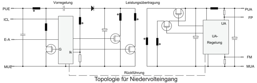
Die Ausgänge sind überlast und dauerkurzschlußfest. Der Ausgang läuft gegen Kurzschluß (definierte kapazitive Last) an und ist bedingt (ohne geregelte Lastaufteilung) parallelschaltbar bei einem Derating ab 60°C. Die Fühlerleitungen kompensieren lastabhängige Spannungsabfälle.
